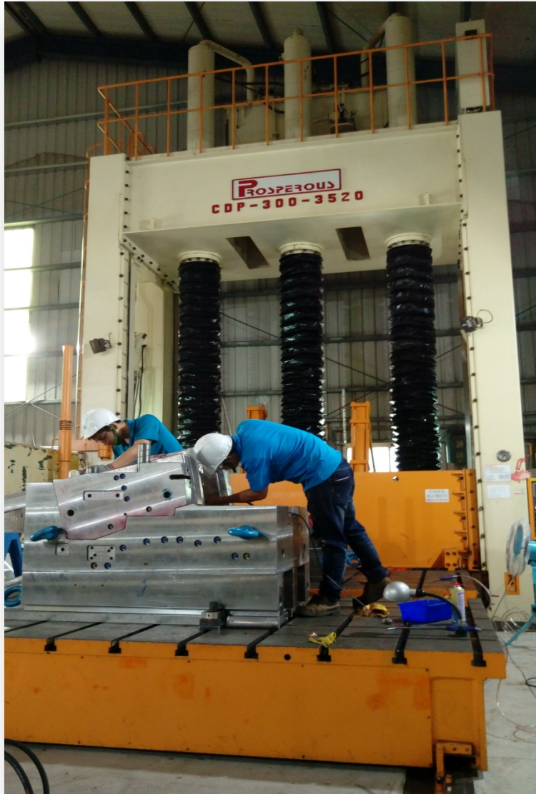
DIE SPOTTING PRESS Press.max=300ton 3500 X 2000 X 2900 mm
